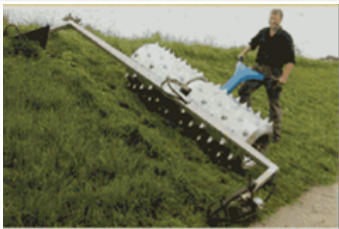
Tweewielige trekker met speciale noppen voor taluds
